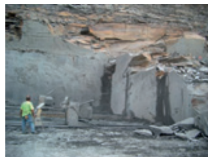
Figura 3. Corte con hilo de diamante en niveles de Morneau, distrito de Valdeorras.
